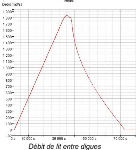
On remarque qu'à partir du moment où la brèche se crée, plus sa largeur augmente, plus parallèlement le débit de la brèche augmente, jusqu'au moment où assez d'eau s'est écoulée et où le débit se met à décroître. En parallèle, le débit se met à diminuer au moment
