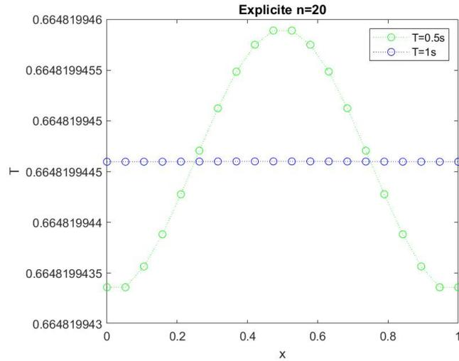
On remarque l'allure de la courbe qui est très similaire à celle obtenue par les conditions initiales. Elle a comme été "aplatie" de par la condition de tangente au bord nulle.
